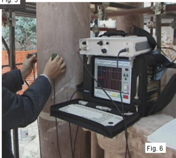
Fig. 6 Tomografia sonica in una colonna in pietra.
