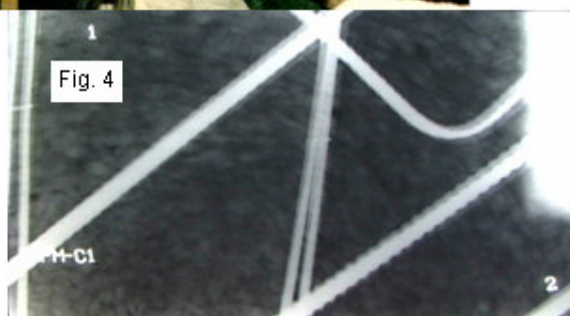
Fig. 3-4 Radiografia di una trave in cls, in evidenza l'armatura lenta.
