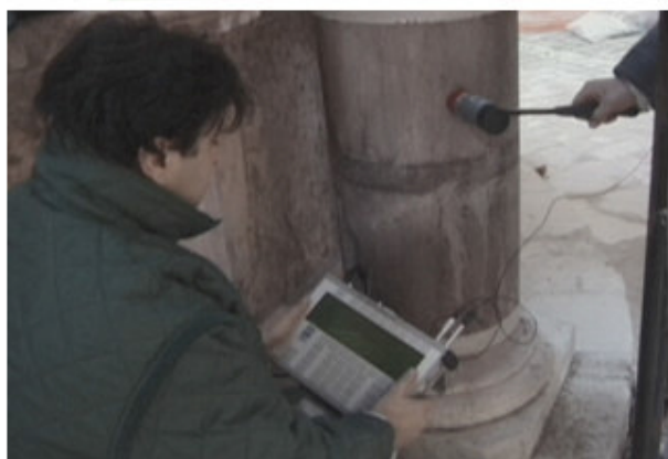
Fig. 1 Indagini sul basamento di una colonna in marmo.
