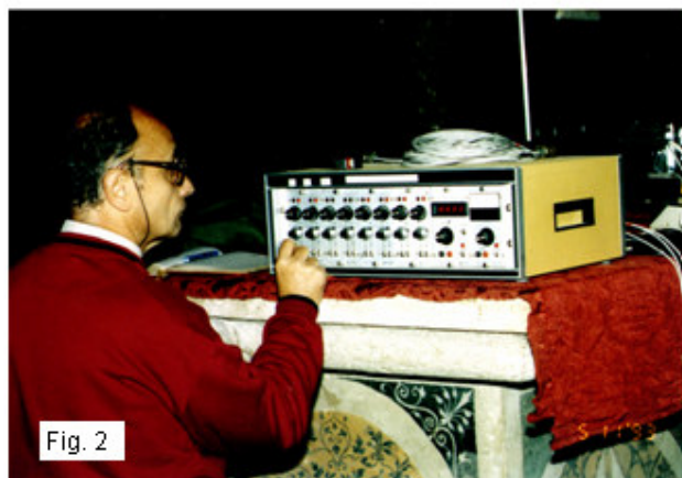
Fig.1 Strain-gage su colonna in pietra Fig.2 Strumento estensimetrico Fig.3 Cablaggio di uno strain-gage Fig.4 Misura su scambiatore
